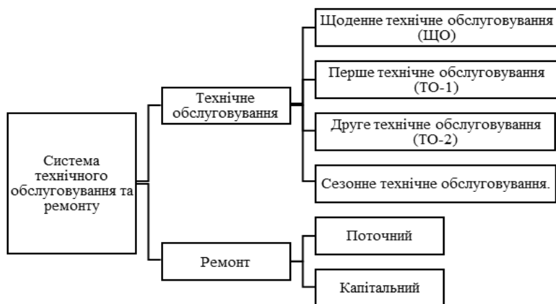
Рис. 1 . Схема технічного обслуговування та ремонту автотранспорту
